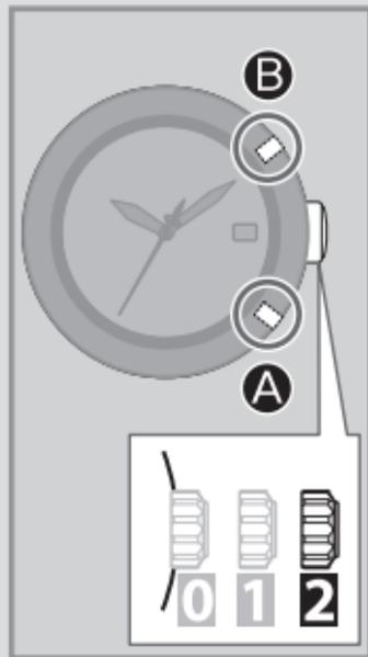
Die Uhr arbeitet möglicherweise nicht richtig, wenn sie durch starke Erschütterungen oder statische Elektrizität beeinflusst wird; die Zeiger stoppen nicht, oder die Uhr arbeitet nicht, obwohl die Uhr ausreichend geladen ist. In diesem Fall führen Sie vollständige Rücksetzung aus.
