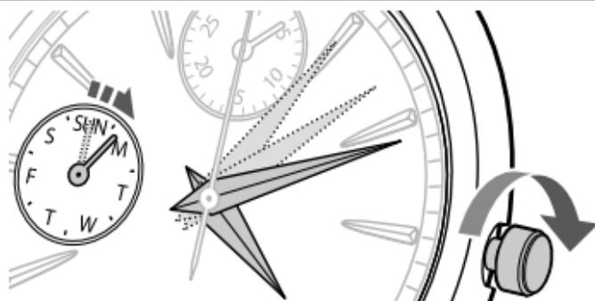
Drehen Sie die Krone nach rechts (im Uhrzeigersinn), um den Tag einzustellen. (Der Tagzeiger bewegt sich, wenn der Stundenzeiger zwischen 0:00 Uhr und 5:00 Uhr morgens steht.)
