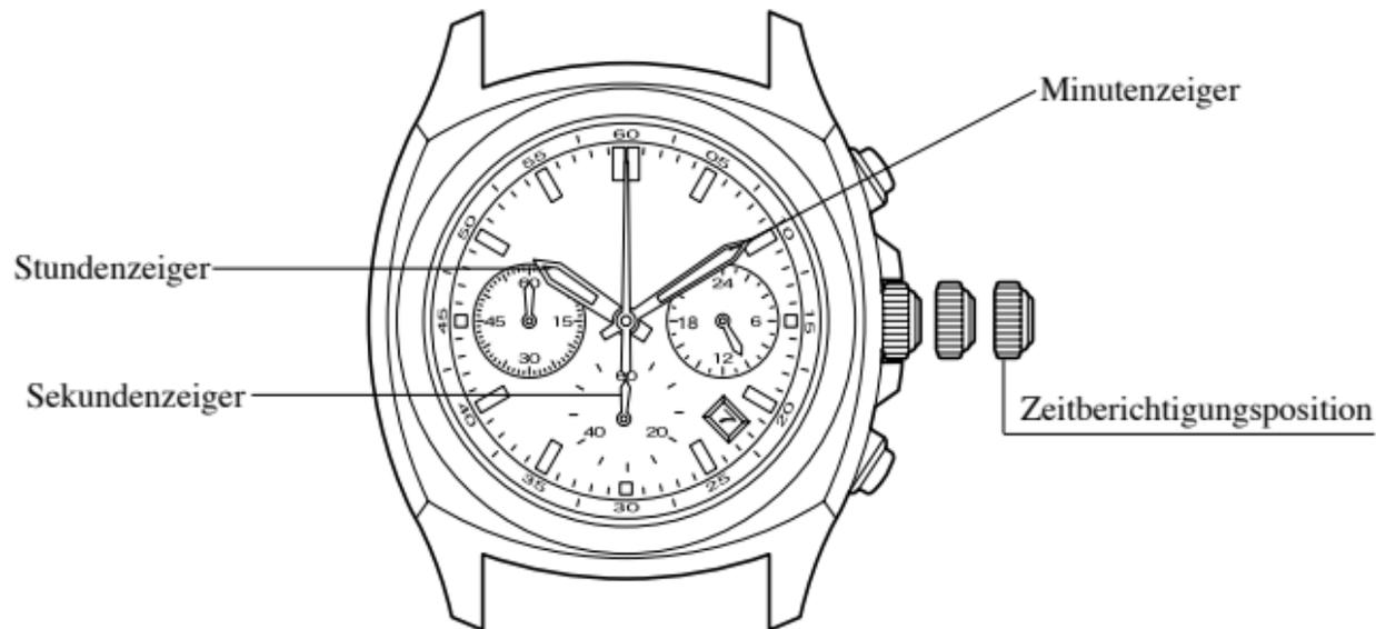
Falls es sich bei der Krone um einen aufschraubbaren Typ handelt, lösen Sie die Krone durch Linksdrehung, bevor Sie die Krone bedienen; nachdem Sie die Krone nach der Bedienung in die Normalposition zurückgebracht haben, drücken Sie die Krone hinein und ziehen Sie diese durch Rechtsdrehung richtig fest.
