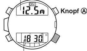
• Tauchzeit wird angezeigt. Während Knopf **A** gedrückt wird, werden die größte Tiefe und die Wassertemperatur angezeigt.
