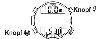
• Tauchzeit wird angezeigt. Während Knopf **A** gedrückt wird, werden die in diesem Tauchgang erreichte größte Tiefe und die niedrigste Temperatur angezeigt.
