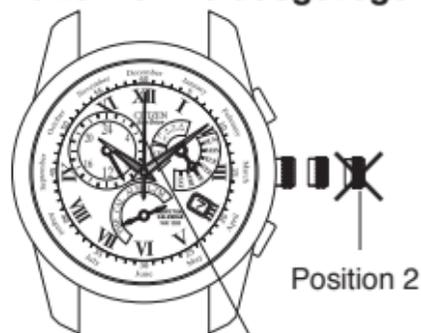
Falls Sie die Krone zu weit in die Position 2 herausziehen, bewegt sich der Sekundenzeiger an die 0-Sekunden-Position, worauf die Armbanduhr auf den Berichtigungsmodus schaltet.
