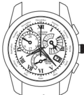
Laden Sie die Armbanduhr auf, indem Sie die Solarzelle dem Licht aussetzen, bis die Armbanduhr wieder in Gang gesetzt wird. Falls die Armbanduhr aufgrund einer unzureichenden Ladung gestoppt hat, sind mindestens 30 Minuten erforderlich, bis die Armbanduhr wieder in Gang gesetzt wird, auch wenn Licht auf die Solarzelle fällt. Laden Sie die Armbanduhr ausreichend auf, indem Sie den Abschnitt „11. Allgemeine Referenz für Ladedauer“ beachten.
